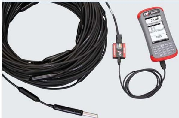
Cadena de termistores visualizada conectada a la consola de mano ultra reforzada PC<sup>2</sup> para una lectura directa. El cable del ThermArray es un cable a prueba de agua y de baja temperatura que proporciona alimentación de energía y acceso digital a los datos de los nodos del ThermArray. Incluye un relleno bloqueador de agua y Kevlar® de alta fuerza y anti extensión para una ubicación durable y precisa.
