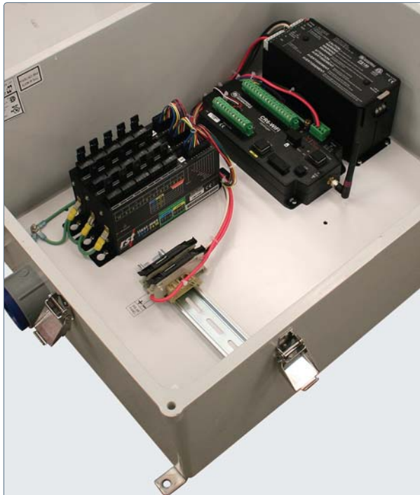
Adquisidor de datos FlexDAQ CR6 (con wi-fi opcional) en una caja de protección a prueba del tiempo con multiplexores Flexi-Mux de RST.
