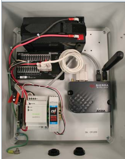
Adquisidor de datos FlexDAQ CR300 presentado con un modem de celular opcional para comunicación de datos.
