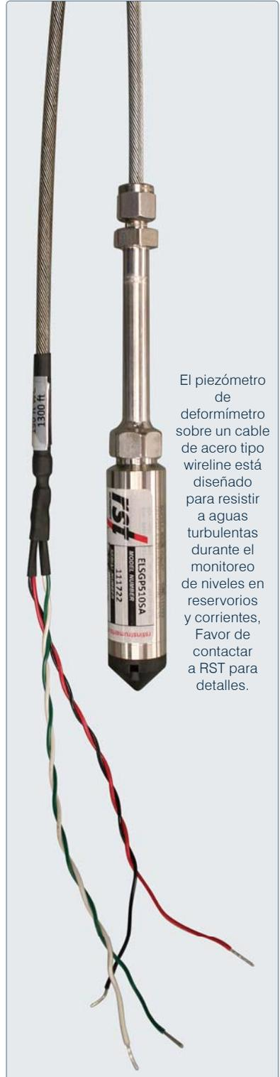
El piezómetro de deformímetro sobre un cable de acero tipo wireline está diseñado para resistir a aguas turbulentas durante el monitoreo de niveles en reservorios y corrientes. Favor de contactar a RST para detalles.
